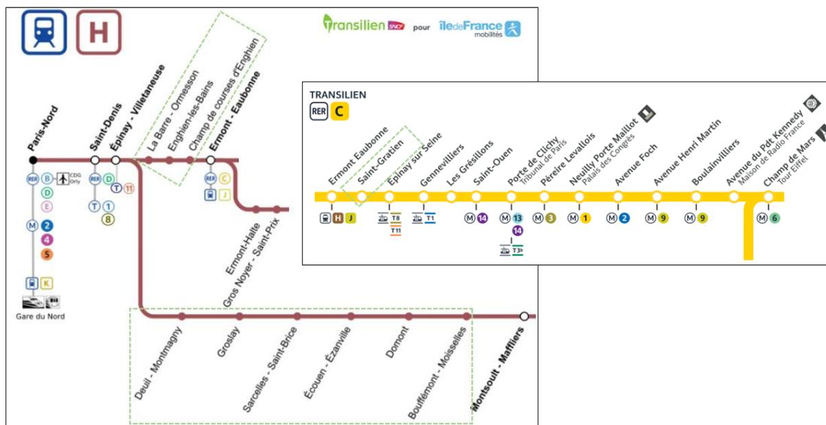
Sur ces voies ferrées situées majoritairement dans des milieux urbanisés, les vitesses limites des lignes H empruntées s'étagent de 60 à 120 km/h. Sur la section d'Epinay-Villetaneuse à Persan-Beaumont par Montsoult-Maffliers, la vitesse limite de la ligne est de 90 km/h d'Epinay-Villetaneuse à Deuil-Montmagny, puis de 100 km/h de Deuil-Montmagny à Persan-Beaumont.
